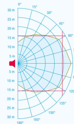
Signalgeber Typ A, geforderter Schalldruckpegel 75 dB(A), DIN-Ton, Geglättete Fläche: Breite 25,6 m / Länge 26,5 m / Fläche 678,7 m<sup>2</sup>
