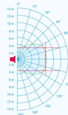
Signalgeber Typ B, geforderter Schalldruckpegel 75 dB(A), DIN-Ton, Geglättete Fläche: Breite 6,4 m / Länge 7,5 m / Fläche 48,0 m<sup>2</sup>
