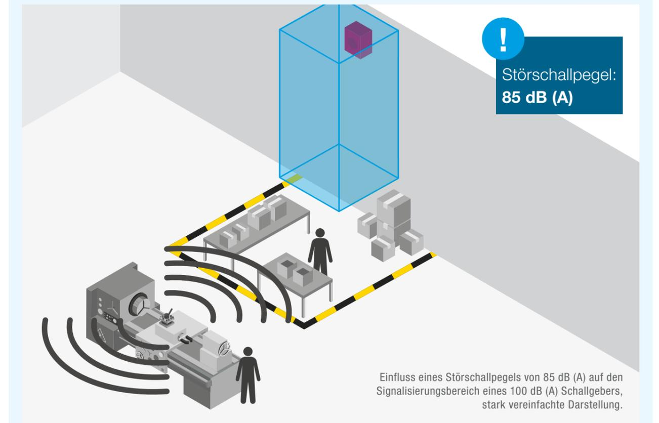
Das Beispiel zeigt die Einwirkung von zwei unterschiedlichen Störschallpegeln auf die 3D-Coverage eines 100 dB (A) Schallgebers.
