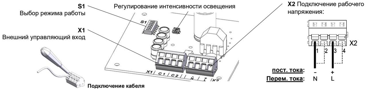
**Указание:** Устройства, работающие от напряжения пост. тока, оснащены защитой против инверсии полярности. Нет функционирования при инверсии полярности соединений.
