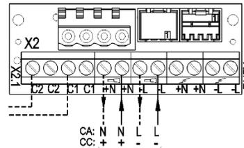
Raccordement de la tension de service
