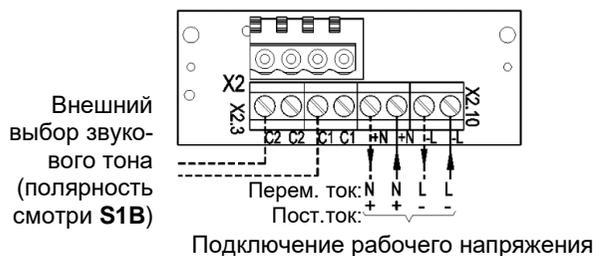
Совместное подключение лампы-вспышки и излучателя звука (Заводская установка)
