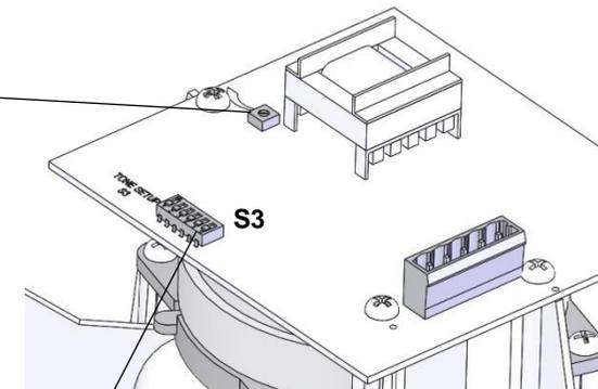
Необходимый звуковой тон можно выбрать с помощью переключателя звуковых тонов S3. После подачи напряжения питания генерируется звуковой тон. Полная таблица звуковых тонов находится в приложении. Для внешнего управления другими звуковыми тонами смотри цифровое руководство по эксплуатации, источник: [www.pfannenbergl.com/manuals](http://www.pfannenbergl.com/manuals)
