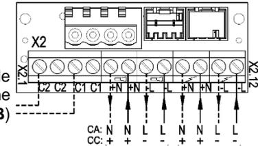
Raccordement de la tension de service pour la sirène
