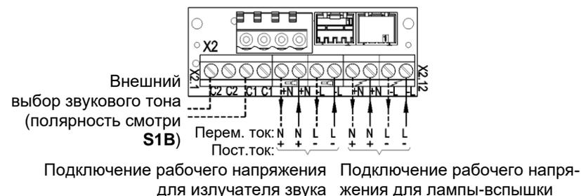
Настройки звукового тона (на плате драйвера в верхней части)
