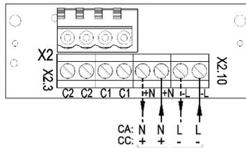
Raccordement de la tension de service
