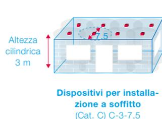
Fig. 9: Numero di dispositivi necessari per categoria di omologazione. Se il soffitto della stanza fosse più alto di un solo 1 cm, la terza opzione non potrebbe essere impiegata.
