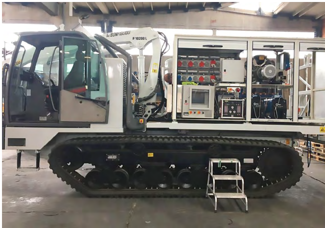
Pfannenberg Kühlgerät an einem Schaltschrank auf einer SICIM-Schweißbraupe
